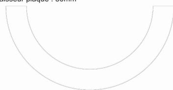
Une réalisation d'un contenant (le nid) de 120 cm de diamètre, profondeur 25 cm, composé de 8 modules circulaires décroissants de 30 mm d'épaisseur taillés dans des plaques de polystyrène expansé en demi-cercle.
